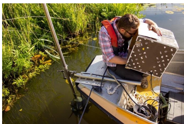
Figur 3. Filmning med ARIS, en akustisk kamera helt oberoende av ljus som skapar en bild utifrån ljud. Funktionen går att likställa vid dagens ekolodsteknik. Foto: Rickard Gustafsson.
